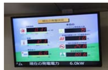
発電状況を確認できるモニタパネル。このモニタは小中学校ともに生徒玄関付近に設置しており、現在の発電量などを子どもたちが関心を持って見る事ができる。
